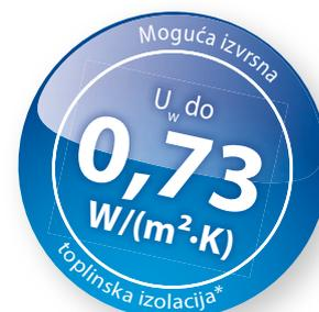
\* Osnova za izračun: Staklena konstrukcija s folijom za zaštitu od topline i "Ultimate Swisspacer", s U<sub>f</sub> vrijednosti = 1,0 W/(m²·K)
